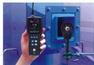
管道出风口测试
